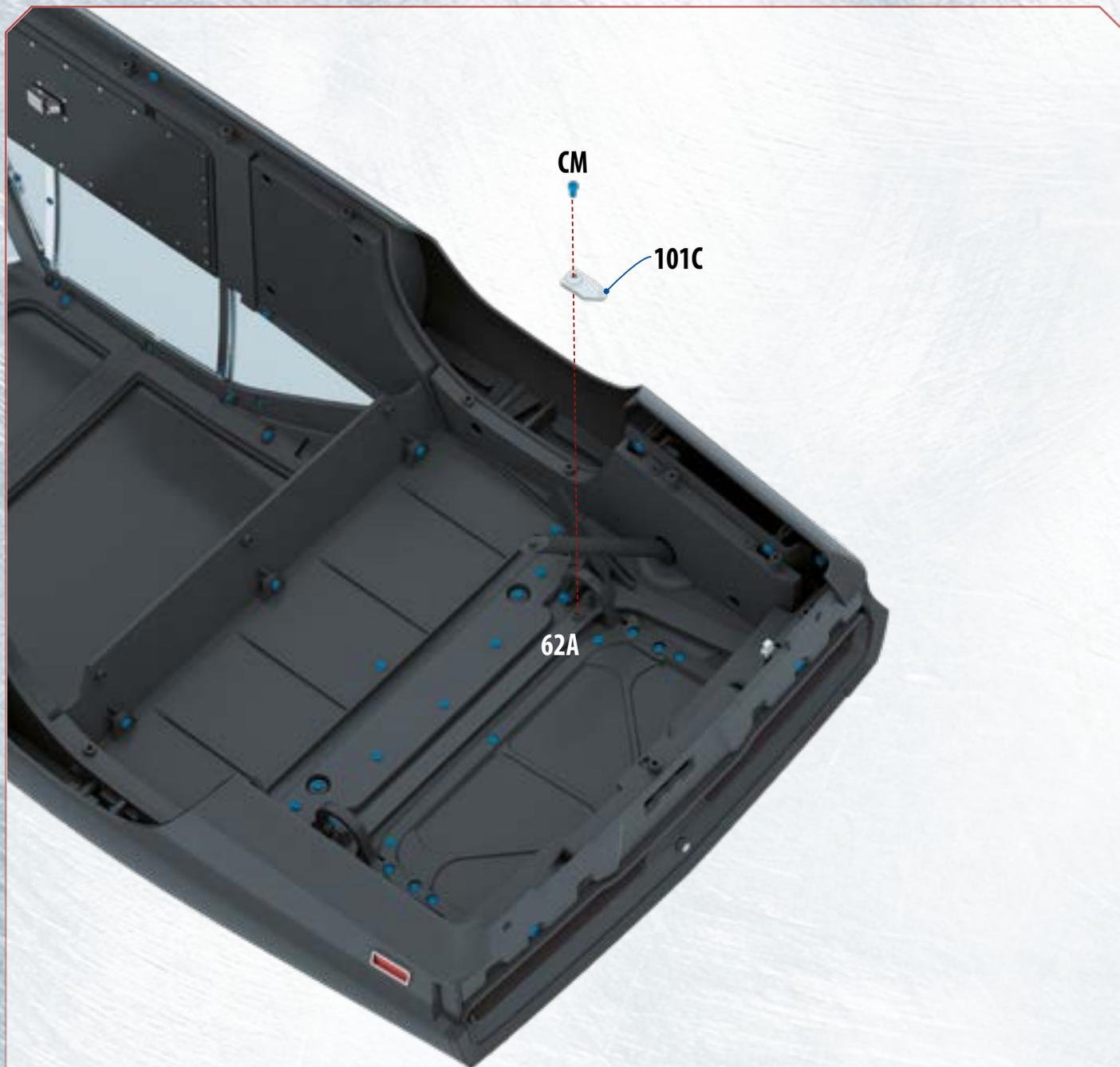
**101.3** С помощью винта **CM** закрепите левый упор петли багажника **101C** на левой стороне задней части кузова **62A** так, как показано на фотографии.▲
